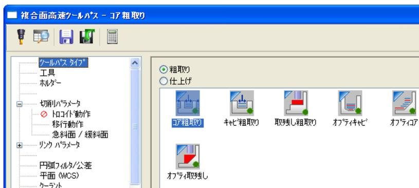
⑤ この先の操作は、各加工方法へ分かれます。切削に関するパラメータを定義する前に、工具とホルダーを定義工具、ホルダー設定は P118～123 を参照して下さい。高速ツールパスでは、ホルダーの干渉チェック機能が有効になります。
